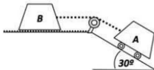
Si el cuerpo **B** tiene una masa de 12,5 kilogramos, ¿con qué valor de aceleración se moverá?
