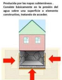
Producida por las napas subterráneas . Consiste básicamente en la presión del agua sobre una superficie o elemento constructivo, tratando de acceder.
