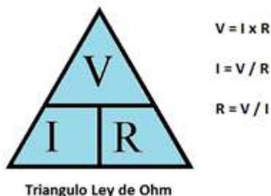
v: diferencia potencial en voltios i: intensidad en amperios R: resistencia en ohms
