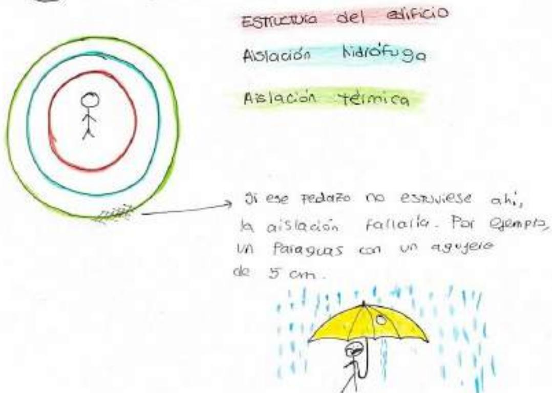
**Aislación hidrófuga:** se consigue mediante materiales muy compactos. Las moléculas están tan juntas que no hay poros, entonces no hay aire, entonces no pasa el agua. Es sólido, compacto que no deja atravesar el agua.
