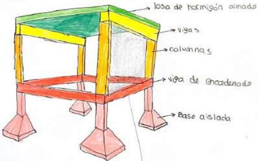
Agregaría Pared (sobre viga de encadenado)
