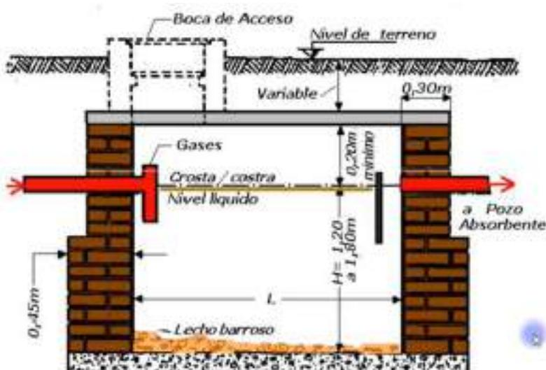
Uno de los elementos que vamos a tener luego de una cámara de inspección si es que vamos a resolver un sistema estático (todo queda en mi lote)
