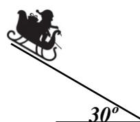
La fuerza impulsora que actúa sobre el trineo, y lo acelera, corresponde a la componente (o proyección) de la fuerza peso en la dirección del techo nevado. Dicha fuerza impulsora tiene un valor de:
