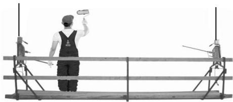
2.- Un andamio de 4 metros de largo, de estructura homogénea y 130 kilogramos de masa, es sostenido por dos cables tal como muestra la figura. A un metro del extremo izquierdo se encuentra trabajando un pintor de 85 kilogramos de masa. Calcule la tensión en cada cable, considere  $g = 9,80 \text{ m/s}^2$  y responda expresando sus resultados con tres cifras significativas y unidades: (2 puntos en total)
