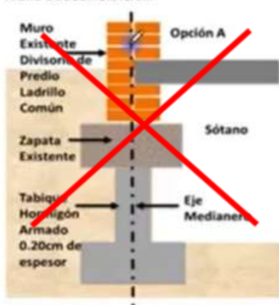
MURO DE SUBMURACION
